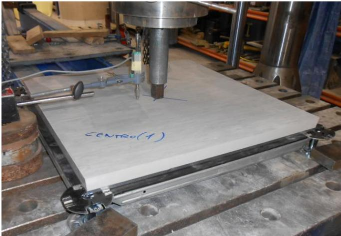
**c : en una diagonal a 70 mm del extremo de la cabeza del pedestal.**
