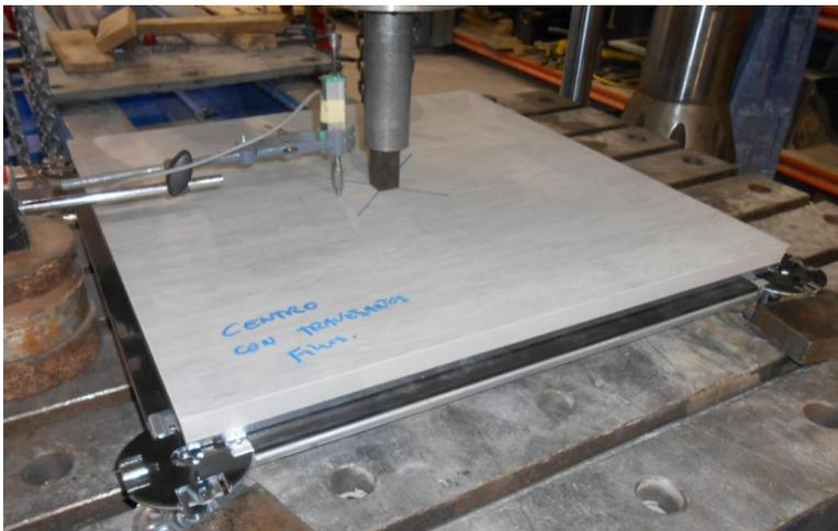
**c : en una diagonal a 70 mm del extremo de la cabeza del pedestal.**
