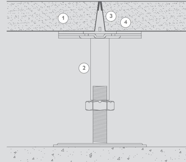
**1 Revestimiento superior chapa de acero galvanizado**
